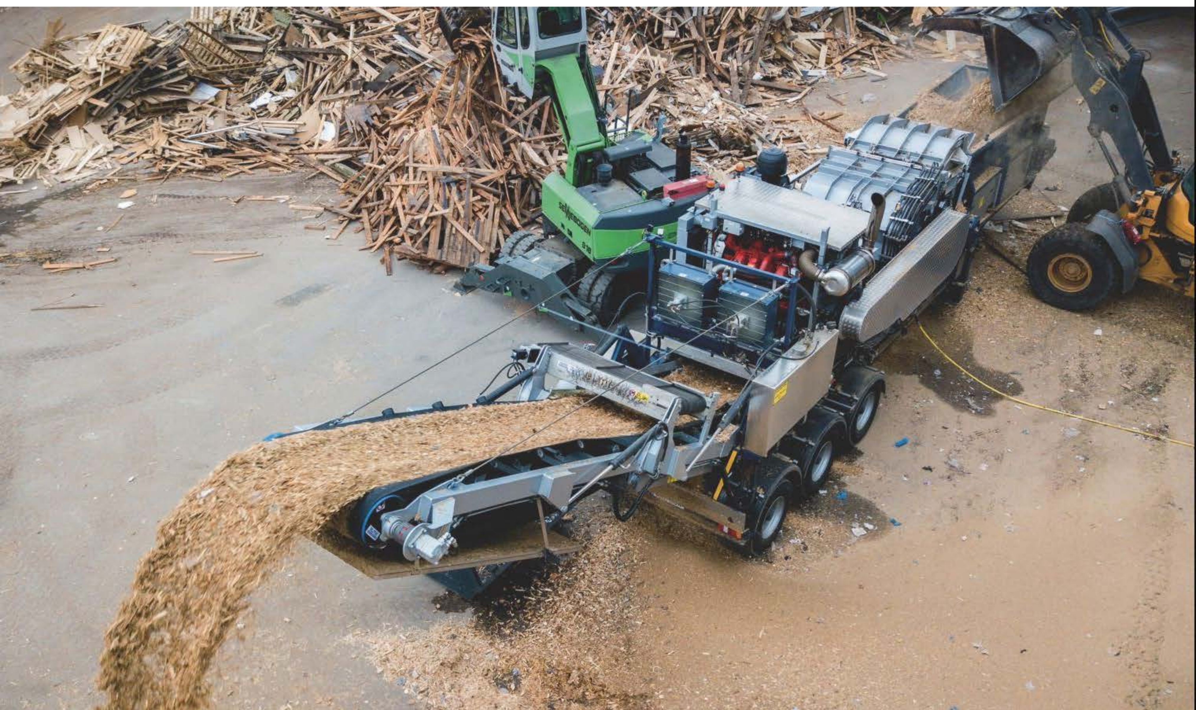
Maskinen krossar materialet i ett steg och kan transporteras mellan olika platser utan särskild dispens.
